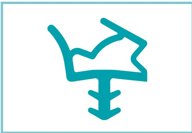
Querschnitt einer originalen Türdichtung (Quelle: Deventer)
