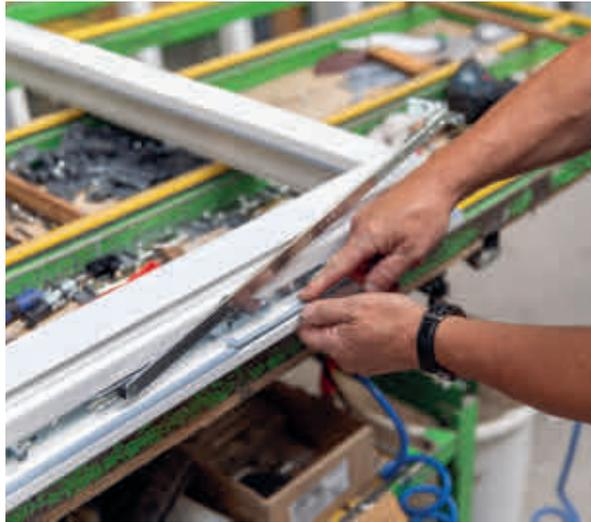
Ein arimeo Fensterfalzlüfter wird an standardisierter Position hinter einer Drehkippsschere eingebaut.
