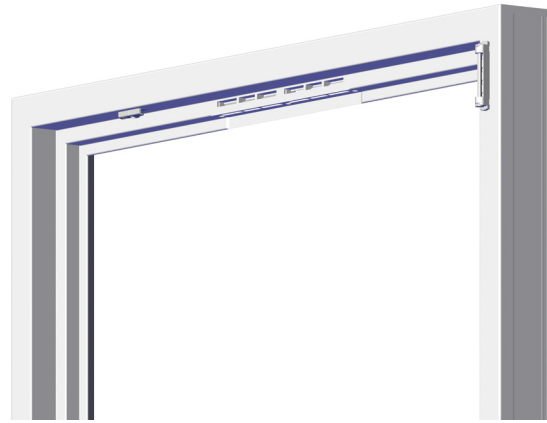
Kłapy zamknięte (przy zbyt wysokim ciśnieniu wiatru)
